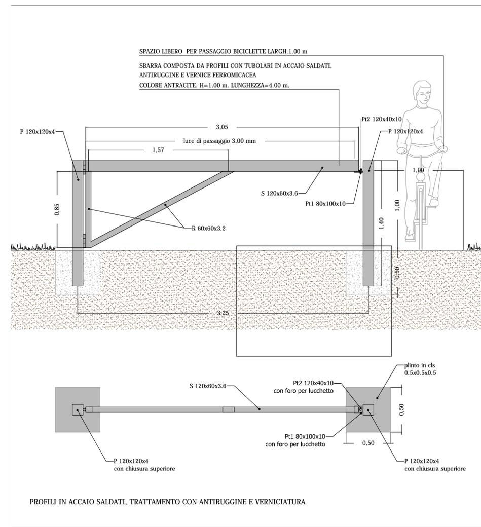
PARTICOLARE 6 - SBARRA METALLICA CONTROLLO ACCESSI - Scala 1:20
