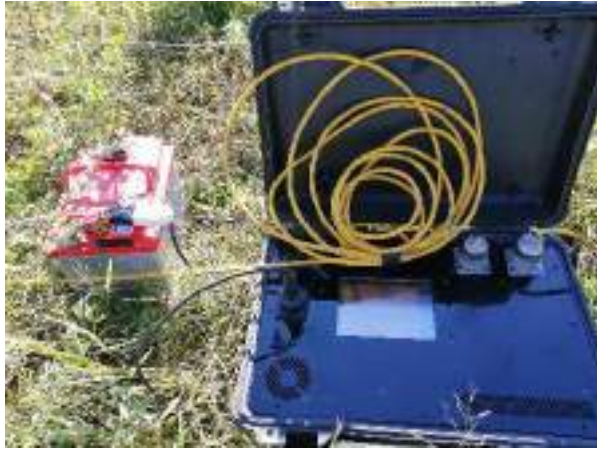
Figura 51 - Attrezzatura per esecuzione indagine MASW
