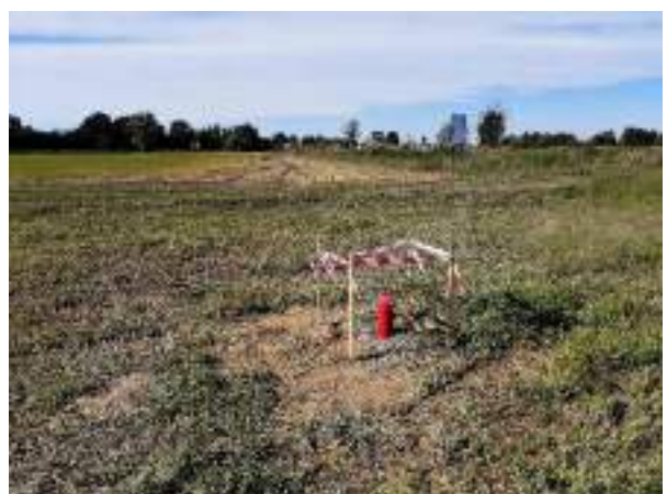
Figura 26 - Allestimento a piezometro
